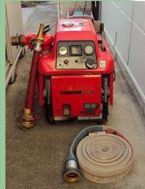
消火ポンプとホース・筒先
